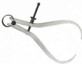
**Los de exteriores:** Con las puntas hacia dentro, se emplea para verificar paralelismo entre caras exteriores, así como medidas de gruesos y espesores.
